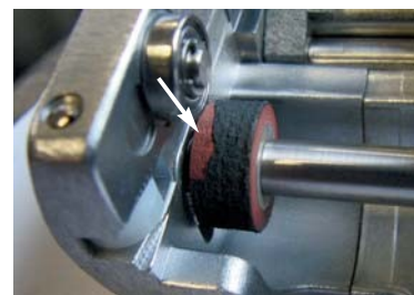
② Rueda de fricción con indicador de desgaste integrado.
